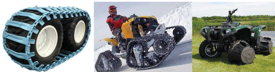
Obr. 1 Ukázky speciálních konstrukcí pro zlepšení průchodnosti terénem: kolo-pás využívaný v lesnictví [4], možnost použití pásových adaptérů a tzv. “J-wheelz“ na terénní čtyřkolce [5]
