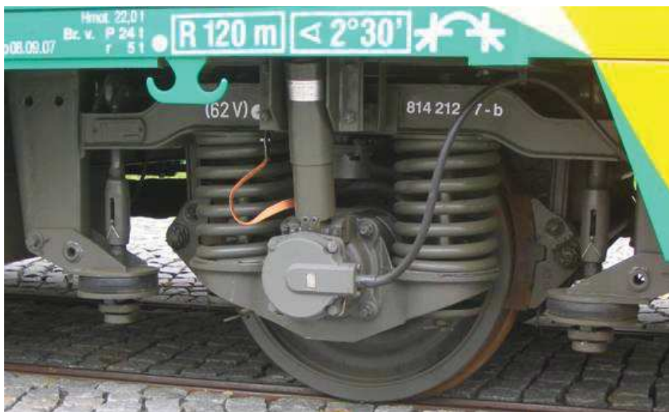
Obr. 7 Jednonápravový podvozek motorového vozu ř. 810 a Regiobnova
