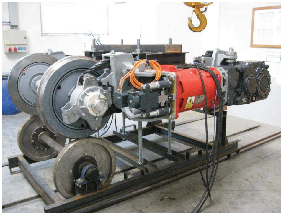
Obr. 6 Nestandardní podvozek pro úzkorozchodnou tramvaj (na zkušební stolici)
