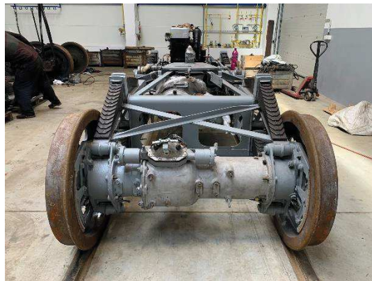
Obr. 5 Pohledy na podvozek Slovenské strely po renovaci
