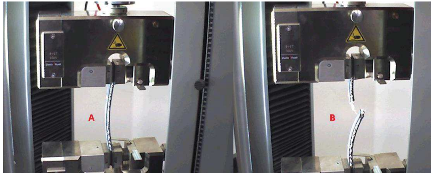
Obr. 3 Vzorka dopravného pásu EP 630/4 800 4+2 Y; A – pred roztrhnutím; B – po roztrhnutí
