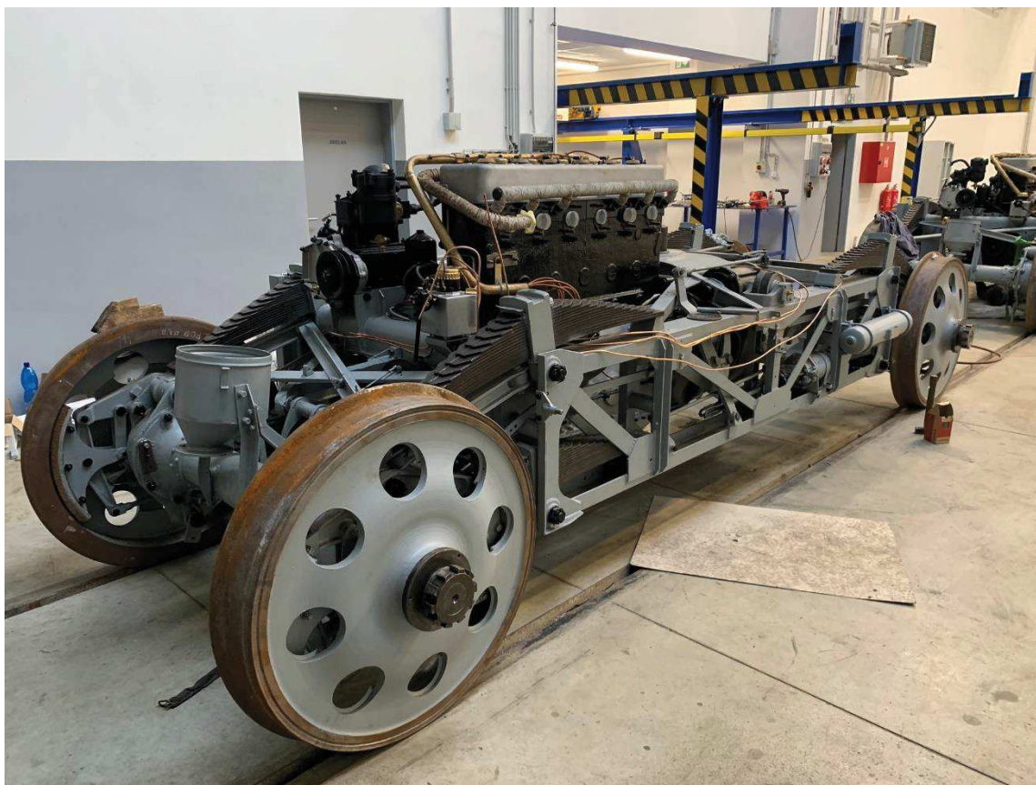
Obr. 4 Podvozek Slovenské strela po renovaci
